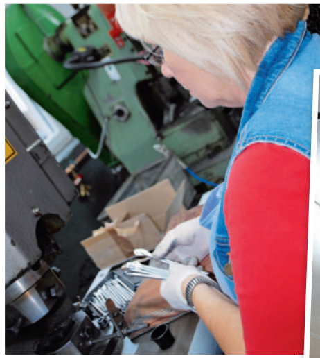
Fachfrau Anke Sadowski prüft an der Häkelnadelmaschine die Nadelqualität.
