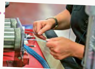
13.-14. Imprimir y cortar los cables y conectarlos a las puntas Cord printing and cutting, con- necting cord and tips
