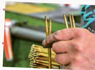
4. Pulir las puntas de las agujas Polishing the points of the tips
