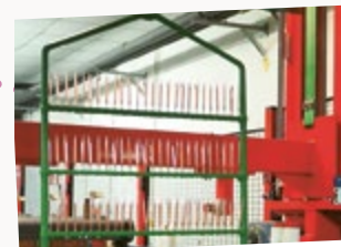
10. Veredelung mit Weißbronze durch 25 Bäder (Galvanik) Refinement with white bronze through 25 baths (galvanic)
