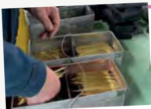
3. Промывание латунных наконечников Washing the tips
