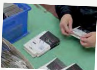
15.-20. Изготовление футляров и упаковка спиц Insert printing and packing needles
